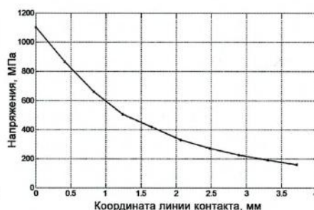
Рис. 5. Контактные напряжения на первом (а), втором (б) и третьем (в) участках линии контакта
