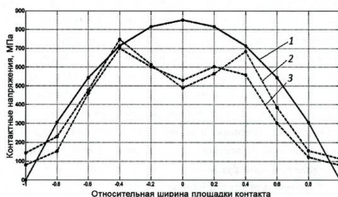
Рис. 8. Закономерность изменения контактных напряжений роликов в рабочей зоне: 1 - теоретическая, соответствующая теории Герца; 2 - для традиционного ролика; 3 - для модифицированного ролика
