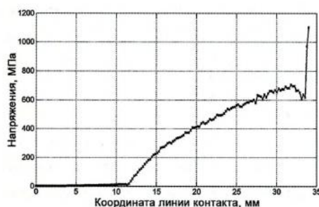
Рис. 5. Контактные напряжения на первом (а), втором (б) и третьем (в) участках линии контакта
