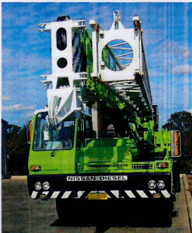
Стрела крана после зачистки и грунтовки в 22-метровой окрасочной
