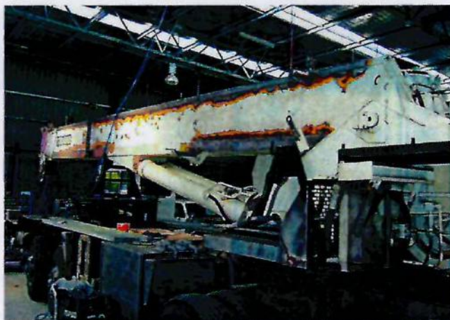
Стрела крана после зачистки и грунтовки в 22-метровой окрасочной
