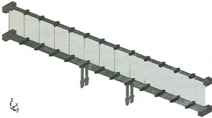
Рис. 8. Расчётная пространственная модель балки крана
